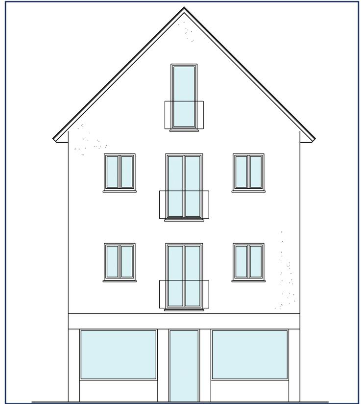
Abb. 137 Schemaskizze möglicher Anordnungen von Schaufenstern bei Neubauten
